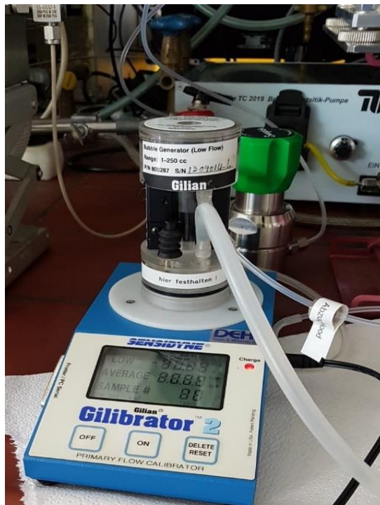
Abbildung 5: Bubble Generator zur Kalibrierung der MFC.
