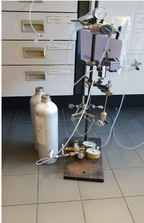
Abbildung 4: Der Aufbau der Gasflaschen, die zur Kalibrierung der GC dienen, wird in dieser Abbildung dargestellt. Die Gasflaschen wurden mittels Sicherheitskette und mit einem Druckregler befestigt.
