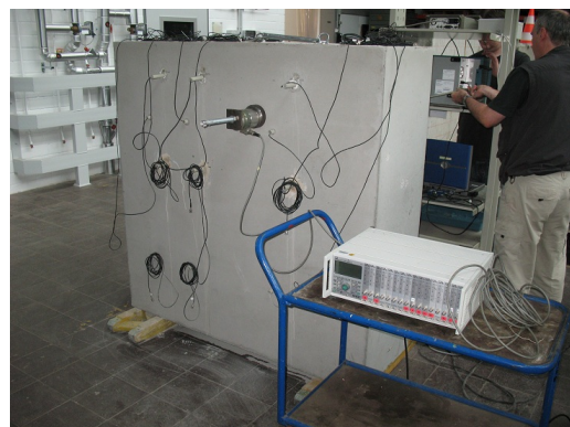
Abbildung 3: Probekörper inklusive Messaufbau und Druckmessdose
