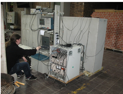
Abbildung 3: Probekörper inklusive Messaufbau und Druckmessdose
